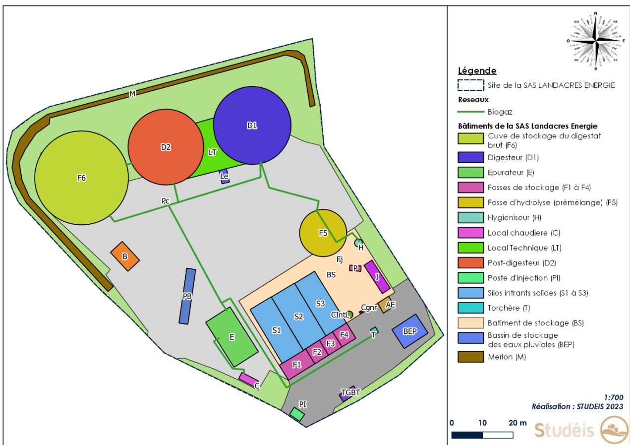
Figure 22. Localisation des canalisations de biogaz du site de la SAS LANDACRES ENERGIE
