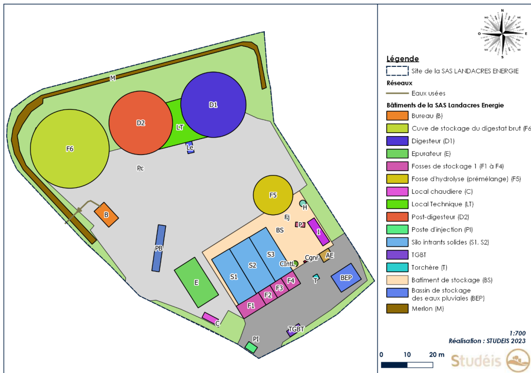
Figure 38. Gestion des eaux usées sur le site de la SAS LANDACRES ENERGIE
