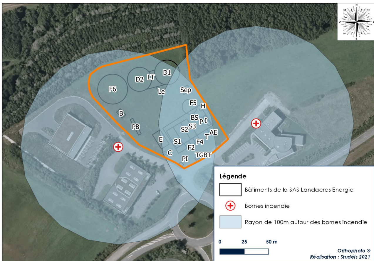
Figure 24. Présentation de la défense incendie du site de la SAS LANDACRES ENERGIE (Source : Studéis)
